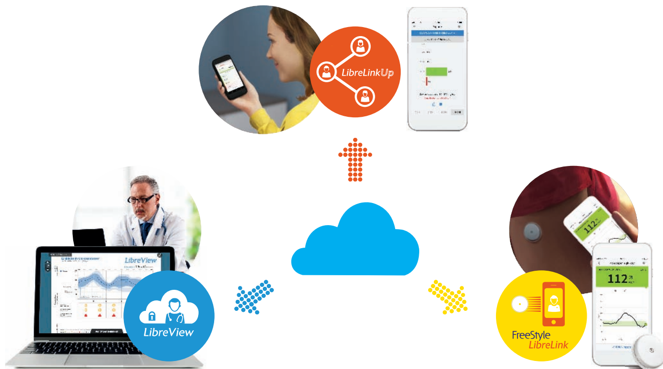
Ryc. 6. Aplikacje systemu FreeStyle Libre: LibreLink (umożliwia skanowanie sensora odpowiednim urządzeniem mobilnym), LibreLinkUp (aplikacja opiekuna) oraz „chmura” LibreView (platforma wymiany danych między pacjentem a lekarzem).
